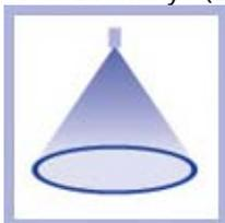
Исключительно равномерное распределение жидкости по поверхности в виде кольца. Самое тонкое распыление, которое можно достичь без помощи воздуха.
